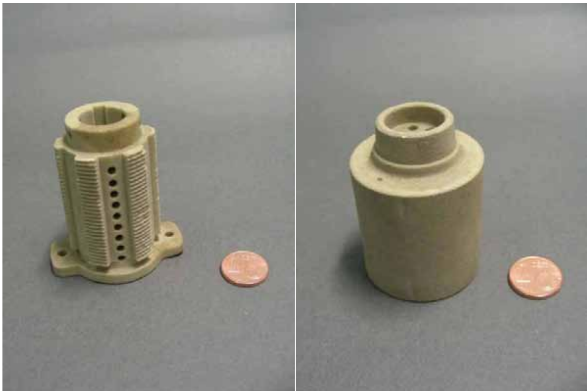
Abbildung 12: Isolierteile für Schalter, aus Steatit, gebrannt, TMW Inv.-Nr. 88284/3+4.
