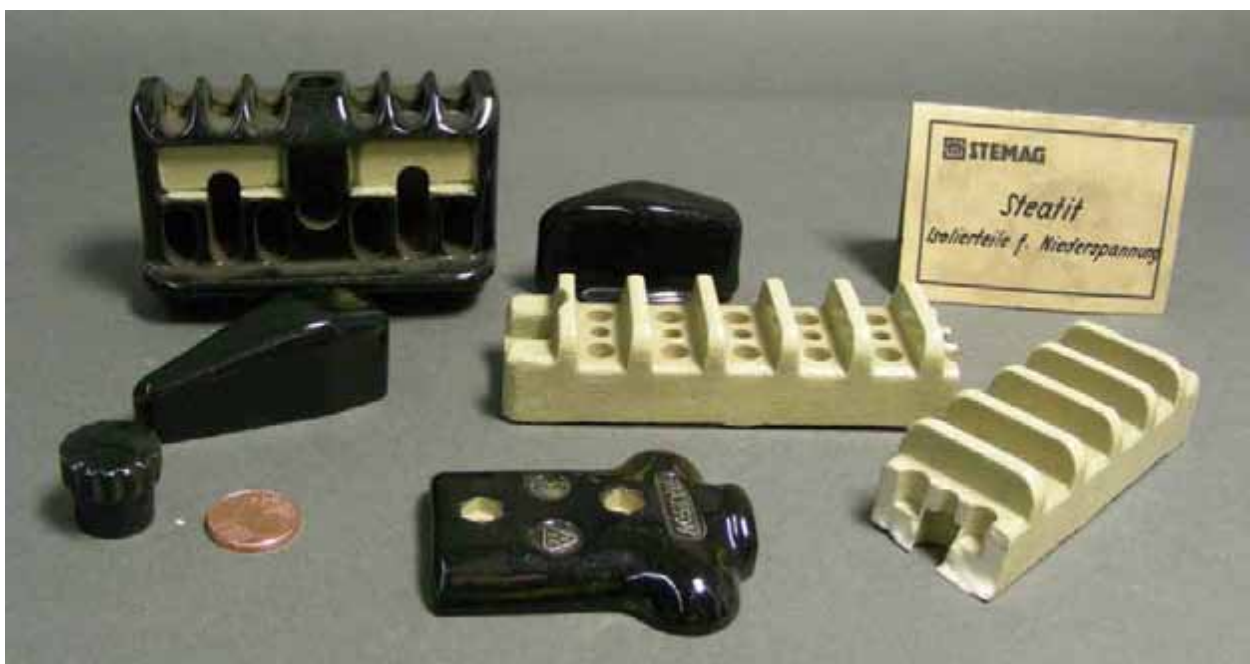
Abbildung 16: Isolierteile für Niederspannung Frequenta, aus Steatit, gebrannt und schwarz glasiert, TMW Inv.-Nr. 88282.
