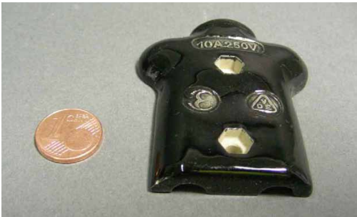
Abbildung 18: Isolierteil Frequenta, aus Steatit, gebrannt und schwarz glasiert, TMW Inv.-Nr. 88282/6.
