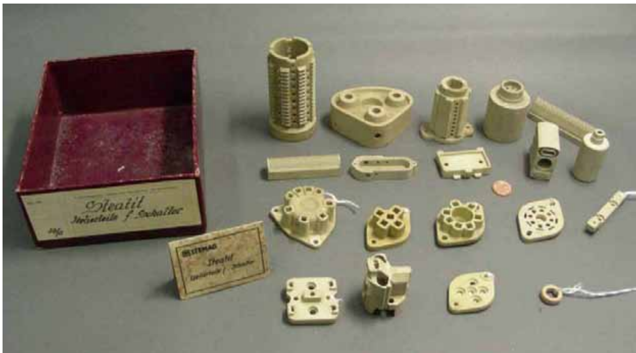
Abbildung 9: Isolierteile für Schalter, aus Steatit, gebrannt, TMW Inv.-Nr. 88284.
